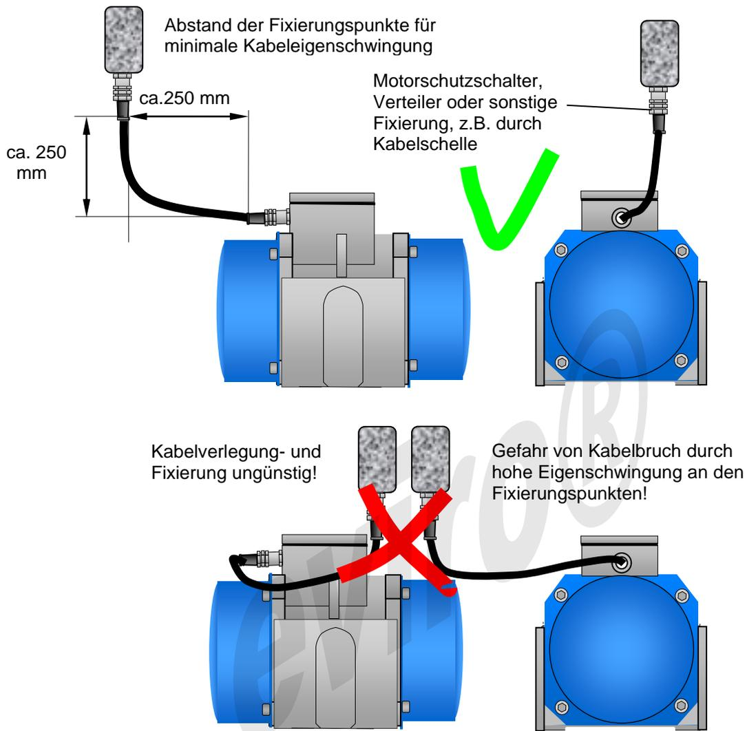
Abbildung 7 Kabelverlegung Anschlussleitung
