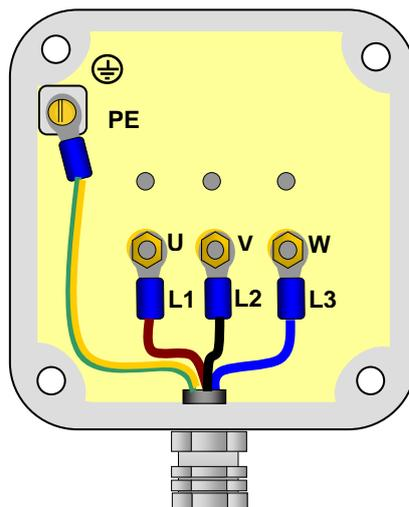
Abbildung 5 Klemmkastenbelegung
