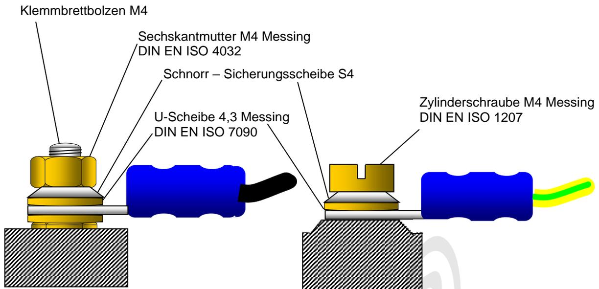
Abbildung 6 Ausführung der elektrischen Anschlüsse im Klemmkasten
