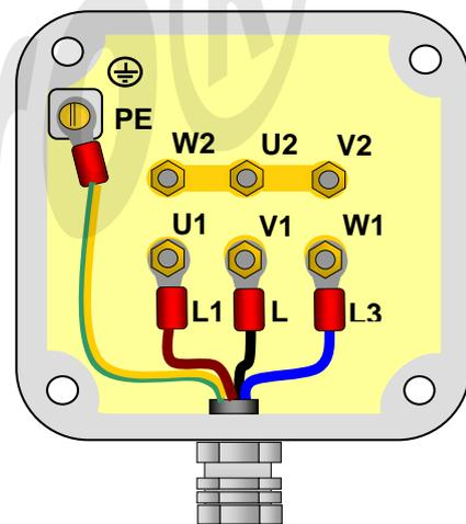
Abbildung 4 Klemmkastenbelegung
